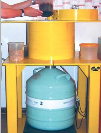
Messung einer Probe im Gammaspektrometer des Umweltinstitut München e.V.
